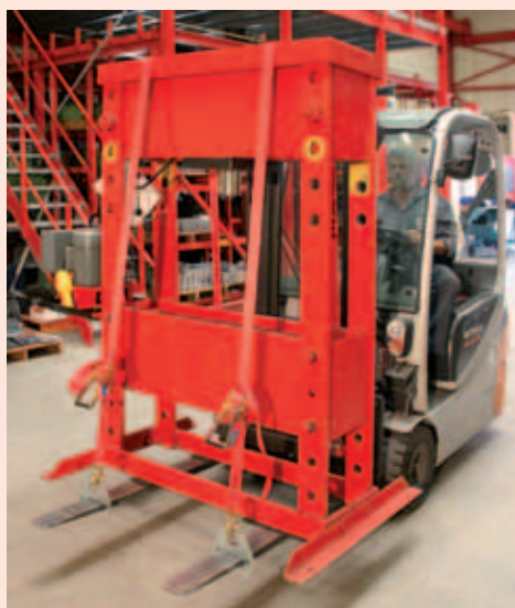
Sécuriser les charges avec les pinces et sangles d'arrimage
