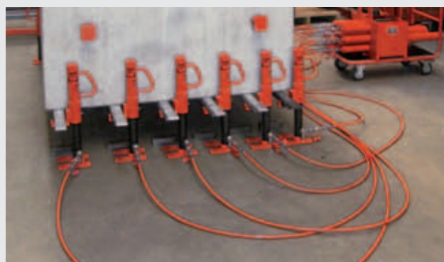
Presse synchrone spéciale pour levage avec 12 crics. Klantspecifiek doseersysteem voor het heffen met 12 machineheffers
